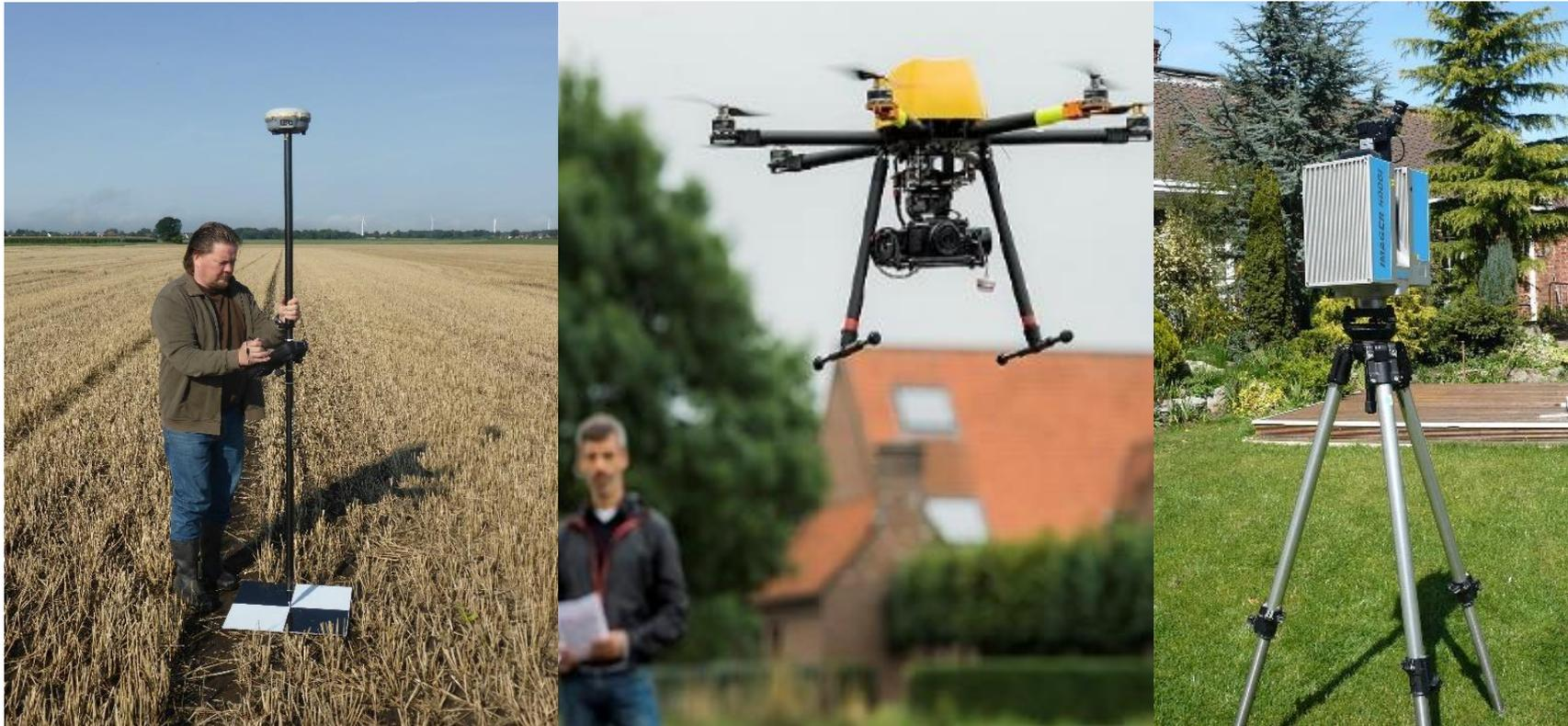
... mit **GNSS, UAV** und **terrestrischem Laserscanner**
