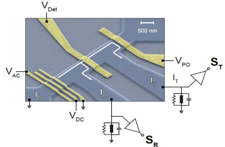
Elektron-Pumpe als Stromwaage
